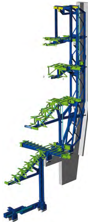
Bild 17. Werkstattplanungsmodell einer Primärstahlrippe (HASLINGER Stahlbau GmbH)
